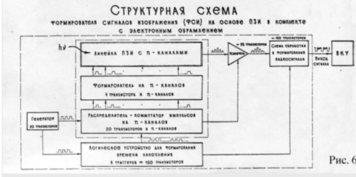
Рис. 5 и 6. Структурные схемы формирователей сигналов изображения в комплекте с электронным обрамлением.
